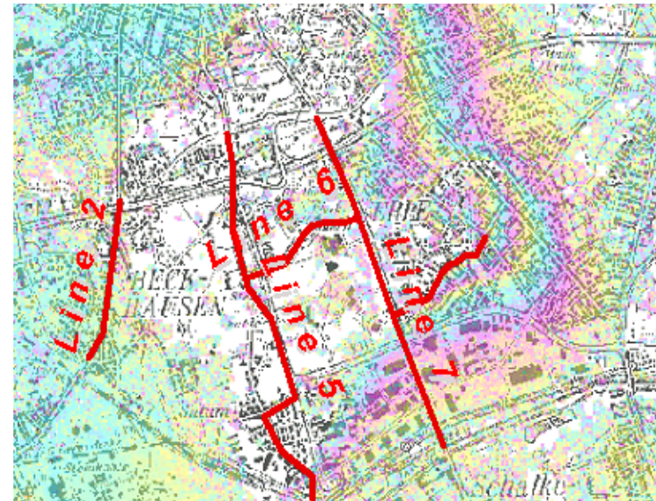
Abbildung: DInSAR Ergebnis Bergbauinduzierter Bodenbewegungen
