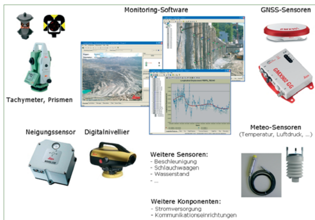
Abb.1: Typische Komponenten eines Monitoring-Systems
