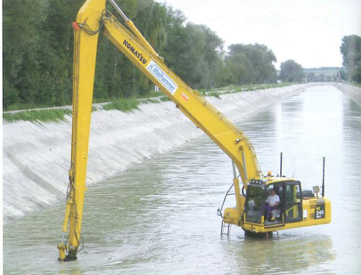
Zwei Satelliten-Empfänger ermitteln Position und Orientierung des Baggers, weitere Sensoren liefern die Lagedaten der Schaufel. Damit lässt sich deren Position in Echtzeit auf 2 cm genau bestimmen. Für den Einsatz im Wasser rüstete Mailhammer den Bagger mit einer Verlängerung zwischen Drehkreuz und Oberwagen aus
