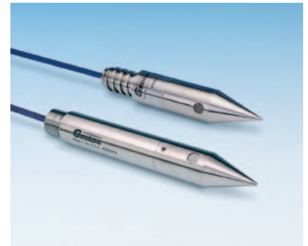
Bild 6: Piezometer zur Porenwasserdruckmessung
